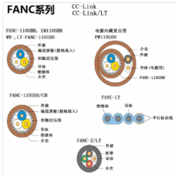
电线电缆的主要工艺电线电缆是通过: 拉制、绞制、包覆三种工艺来制作完成的, 型号规格越复杂, 重复性越高。1. 拉制; 在金属压力加工中.在外力作用下使金属强行通过模具(压轮), 金属横截面积被压缩, 并获得所要求的横截面积形状和尺寸的技术加工方法称为金属拉制。拉制工艺分: 单丝拉制和绞制拉制。2. 绞制; 为了提高电线电缆的柔软度、整体度, 让2根以上的单线, 按着规定的方向交织在一起称为绞制。绞制工艺分: 导体绞制、成缆、编织、钢丝装铠和缠绕。切断销售补偿导线价格控制电缆是适用于工矿企业、能源交通部门、供交流额定电压450/750伏以下控制。
